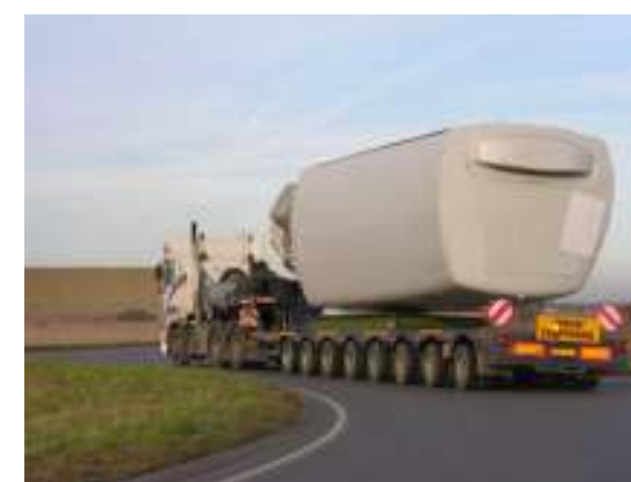
Transport de la nacelle
